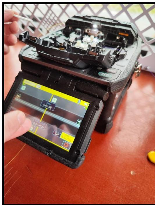
Figure 14 : Photo d'une soudeuse en fonctionnement
